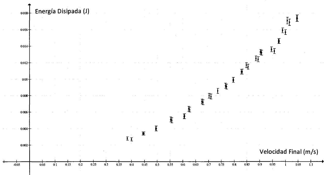
La interdependencia de variables es evidente. Parece ser que la relación es de energía disipada directamente proporcional al cuadrado de la velocidad. Para comprobar esto se linealiza la curva expresando los valores del eje Y como raíces cuadradas de los valores originales:
