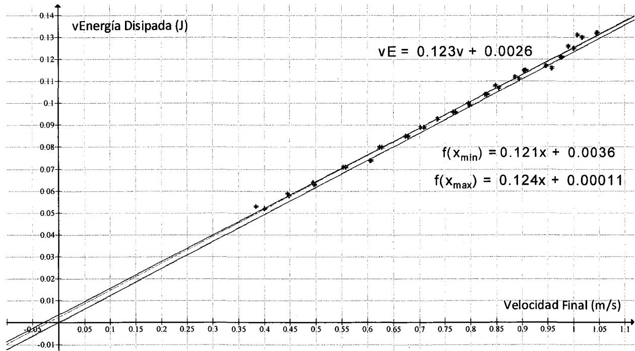
Con esta gráfica se puede determinar la relación entre la energía disipada y la velocidad final:
